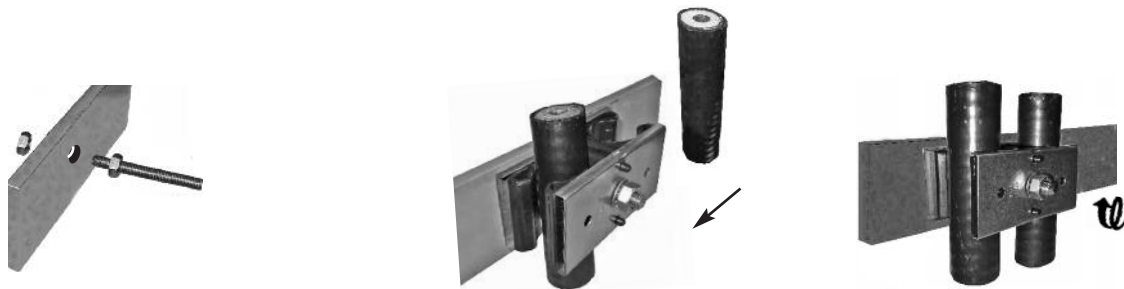
Esempio di fissaggio piatti forati Fixings example on flat iron with holes
