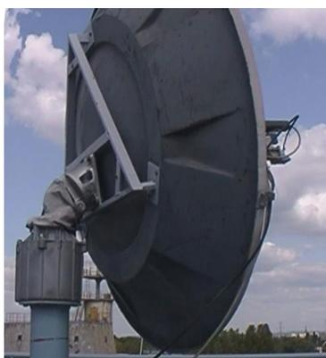
Поворотное устройство (актуатор, ротатор) предназначено для ориентации по азимуту и углу возвышения (элевации) таких объектов как остронаправленные (например, спутниковые) антенны, солнечные панели, концентраторы и зеркала (гелиостаты). Для выполнения этой задачи поворотное устройство состоит из механической части (позиционера по двум осям) и электропривода с редукторами. Наличие блока управления (контроллера) дает возможность слежения за источником излучения (спутник, Солнце и т.п.).
