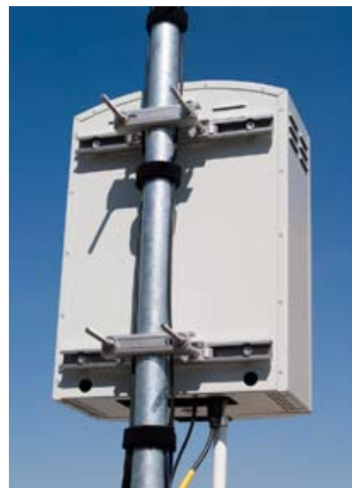
Корпус для механической и всепогодной защиты
